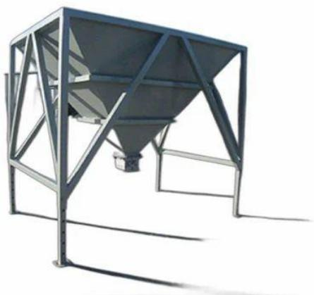
Estrutura de metal em forma de funil para receber os resíduos dos coletores e conduzi-los à esteira transportadora.
