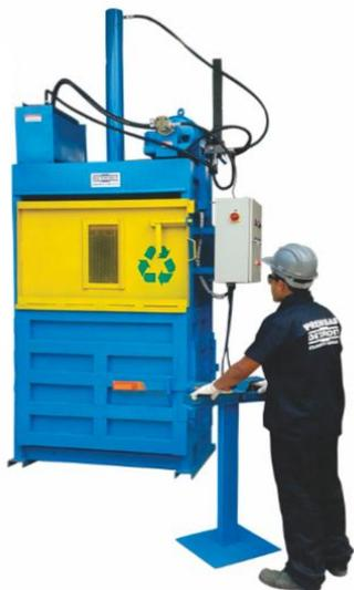
A prensa faz parte dos equipamentos da central de triagem com a função importante de prensagem e enfardamento de materiais depois de separados e agrupados por categorias. A prensagem e enfardamento reduz o volume dos materiais e facilita o transporte, reduzindo despesas e otimizando espaços para armazenamento.
